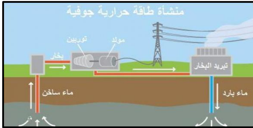
شكل (3) توليد الطاقة الكهربائية من طاقة الحرارة الجوفية لباطن الارض
