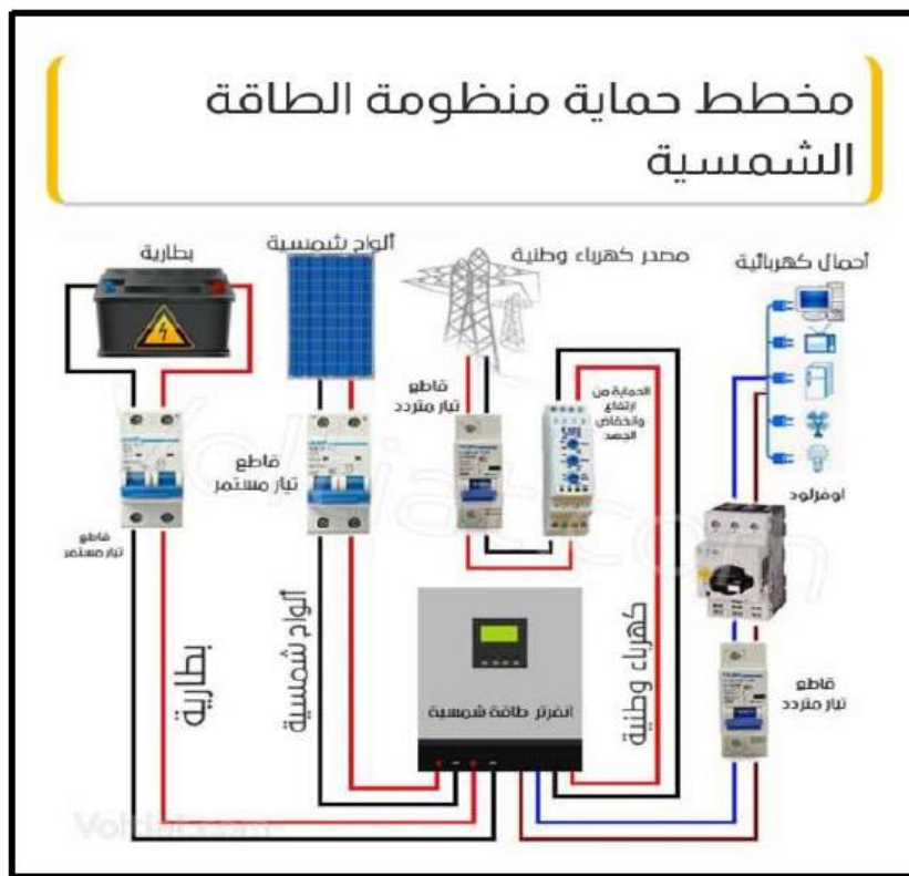
الصورة (4) عمل قواطع التيار المستمر والتيار المتردد في المنظومة الشمسية
